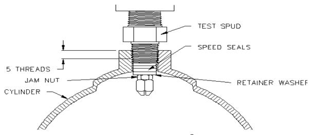
Figure 3 - 1 Hydraclose<sup>®</sup> Seal
